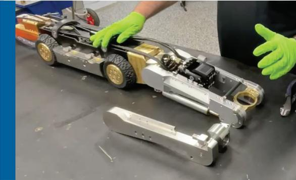
In weniger als 10 Minuten verwandeln Sie Ihren Schwalm-Roboter in einen 2800 bar Wasserstrahlschneider. .
