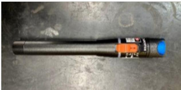
Abbildung 3: VFL- Visual Fault Locator (Gerät zur visuellen Fehlererkennung)
