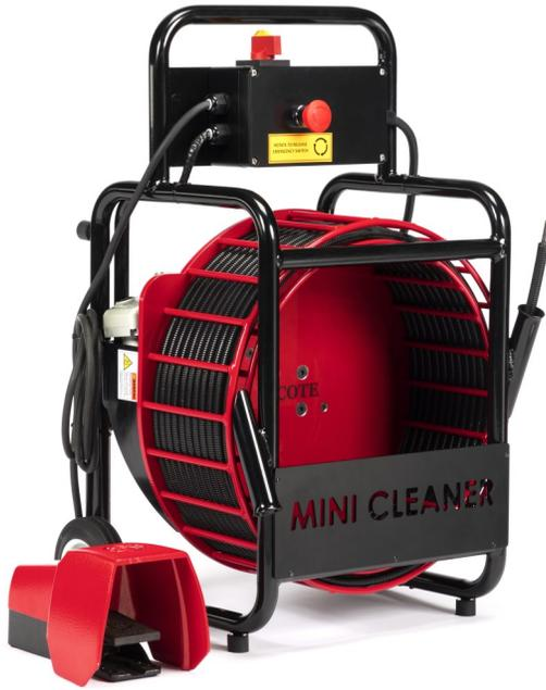
Der Mini Cleaner wurde speziell für Installateure entwickelt und macht das Reinigen, Entkalken, Entfernen von Wurzeln, Fräsen/Instandsetzen und die Beschichtung in Rohren von DN32-75 einfacher als je zuvor.
